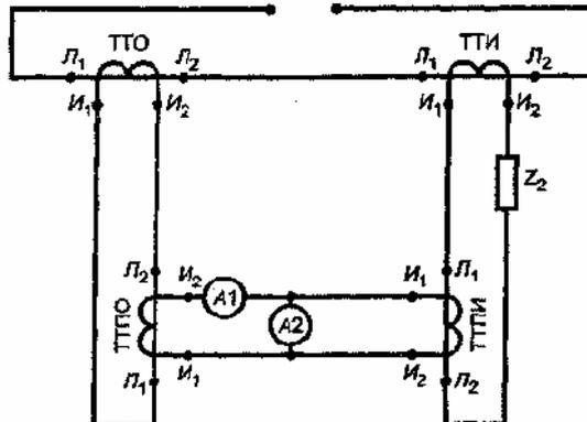
ТТО — образцовый трансформатор тока; ТТИ — испытуемый трансформатор тока;
