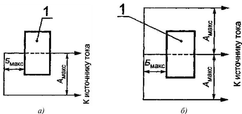
$l$  — испытываемый трансформатор;  $A_{\text{макс}}$  — расстояние между осями проводников соседних фаз в месте установки трансформатора в эксплуатации; — расстояние в свету от трансформатора до места ближайшего изгиба проводника, служащего в эксплуатации первичной обмоткой трансформатора
